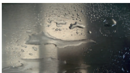
Surface pas assez désoxydée
